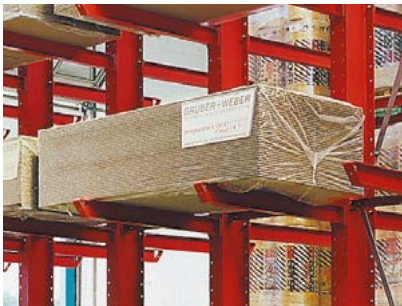
Kragarmregal für Spanplatten Zur sicheren, raumsparenden Lagerung liegen die Plattenpakete auf einer ebenen Auflagefläche.
